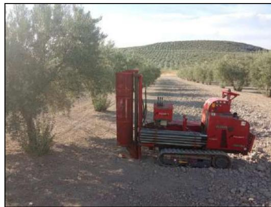
Fotografía 6. Realización de penetros en la zona de Edar-Colectores
